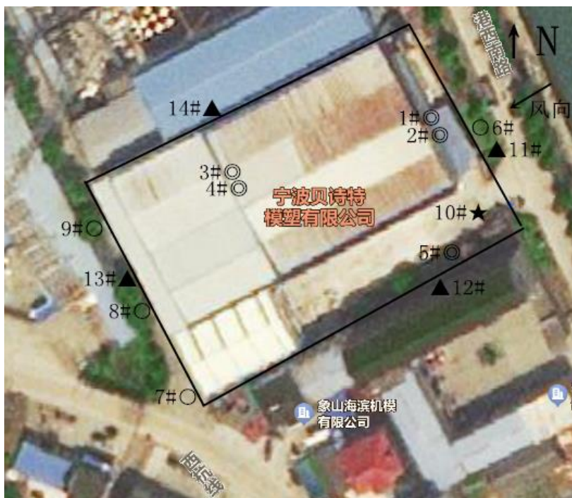
◎-有组织废气采样点；○-无组织废气采样点；★-废水采样点；▲-工业企业厂界环境噪声检测点
